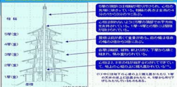
(図42) 五重塔耐震まとめ (五重塔は柔構造)
