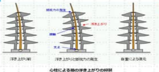
図41 五重塔地震時の変形特性
