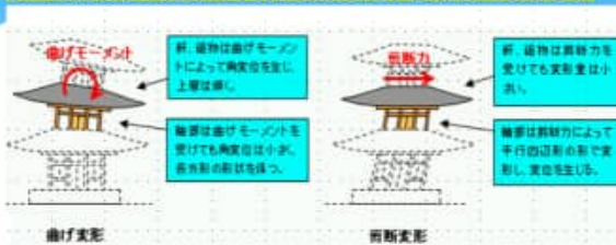
図40: 五重塔柔構造骨組み (応答低減)
